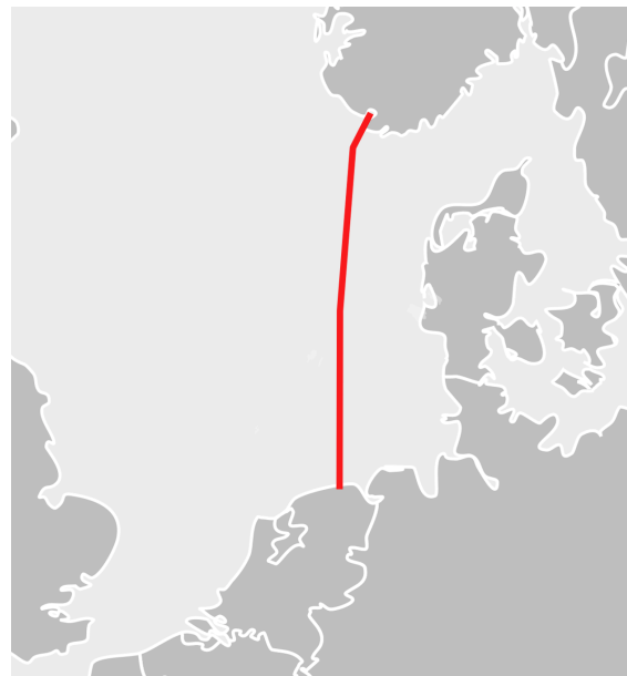
700 MW leiding van Delfzijl naar Noorwegen
